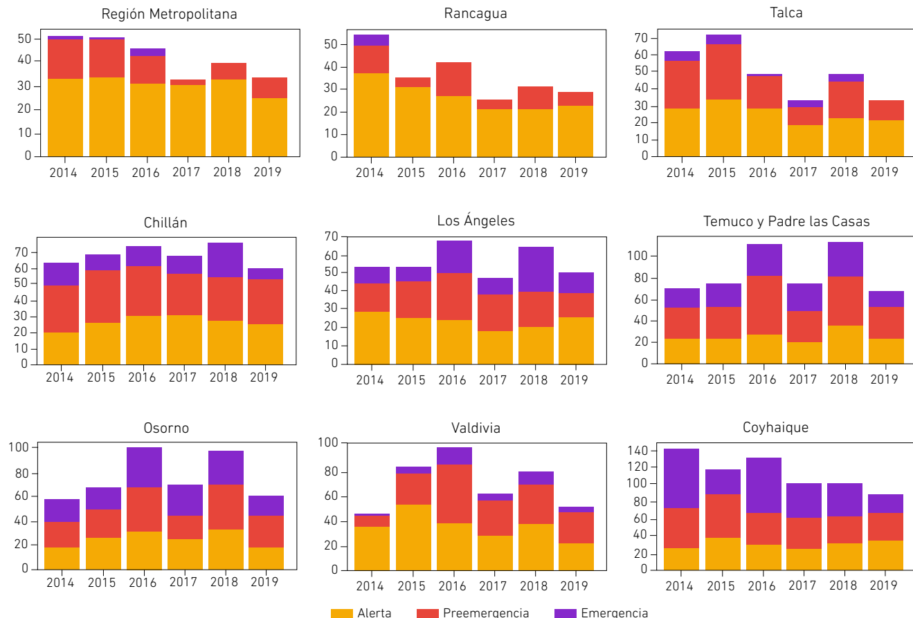
Gráfico 7. Evolución del número de episodios críticos por contaminación MP 2,5 en zonas urbanas
